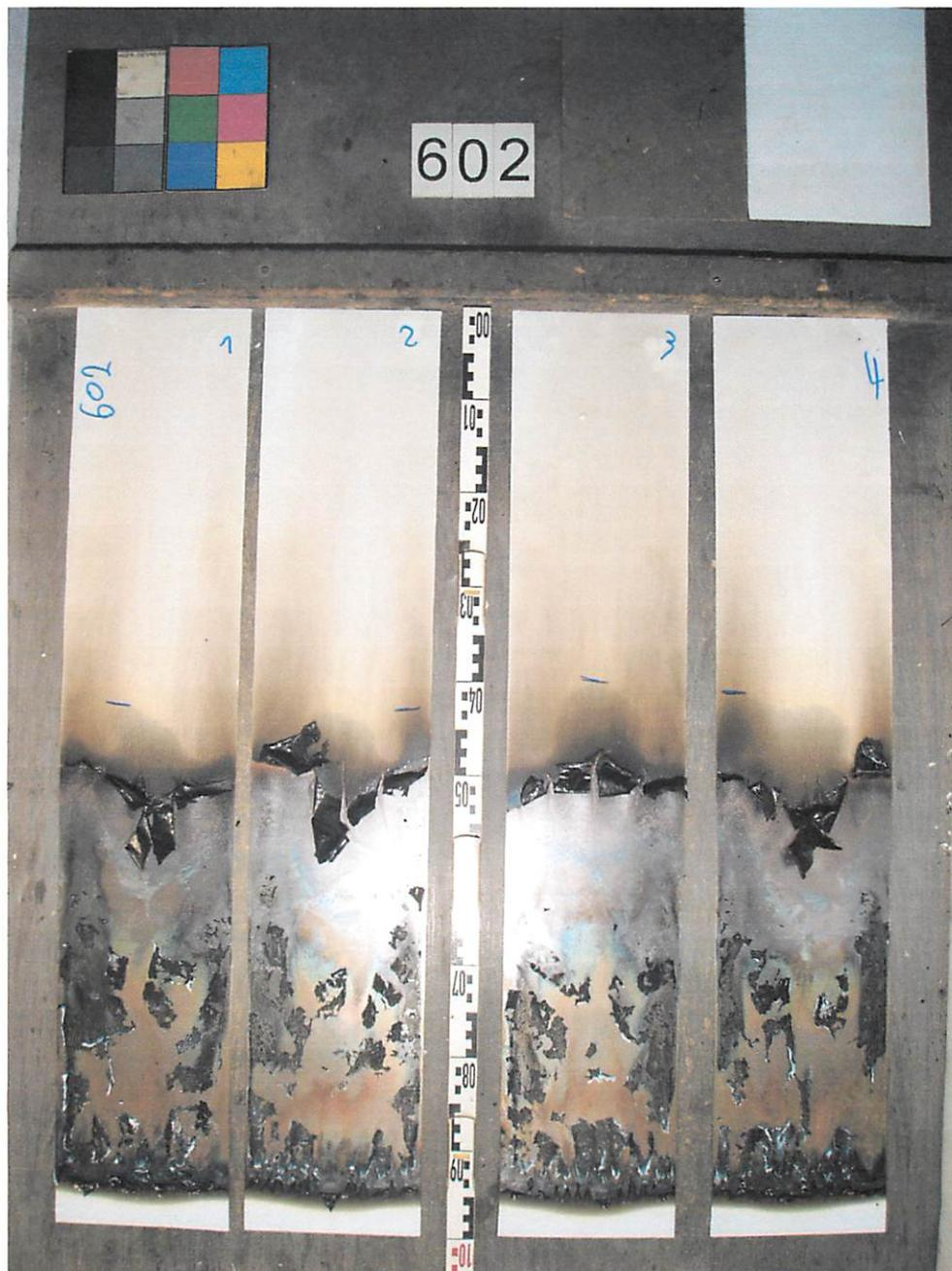
Bild 1: Aussehen des Probekörpers B2 nach dem Brandschachtversuch
